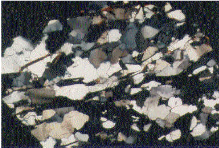
Abb. 4: Dünnschliffaufnahme einer Schlackeprobe mit undulös auslöschendem Quarzkorn; 10-fache Vergrößerung
